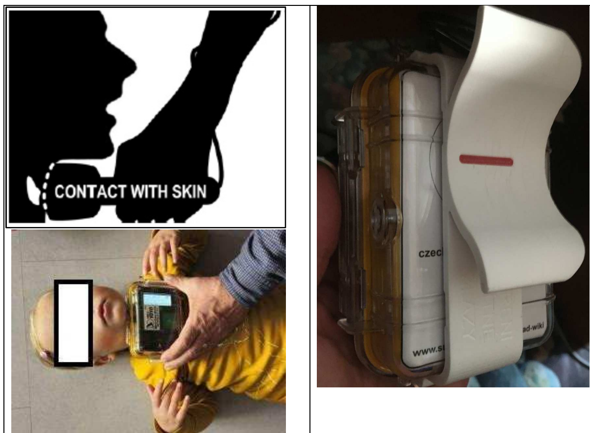
Obrázek 2: Měření dávkového příkonu štítné žlázy v kontaktu s kůží krku (zdroj: [IAEA 2017] vlevo nahoře) a uspořádání měření s CzechRad (vlevo dole) a odnímatelný fixační držák (vpravo)
