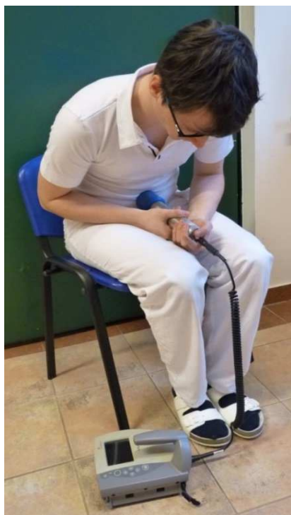
Obrázek 2: Geometrie improvizovaného celotělového měření v geometrii podle [Palmer 1966]
