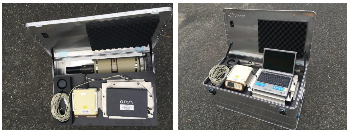
Obr. 7 Polovodičový systém pro letecká měření - HERAS
