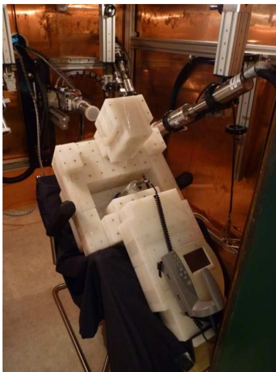
Obrázek 2: Geometrie improvizovaného celotělového měření v geometrii podle [Palmer 1966]
