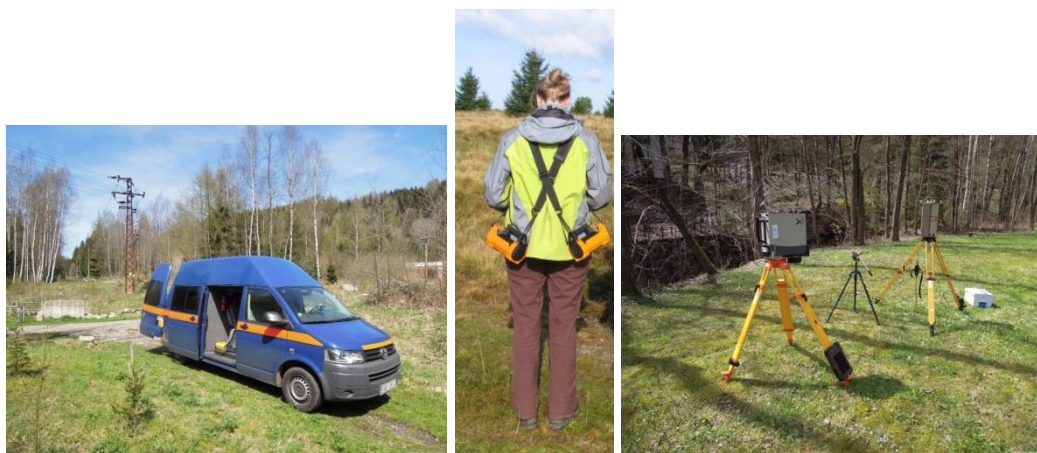
Obr. P 2.4 Monitorovací vůz SÚRO (vlevo); měření pomocí přístrojů RT30 (uprostřed) a polovodičových detektorů (vpravo)
