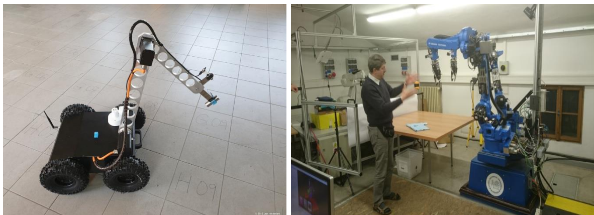
Obr. 1 Ukázka robotů vhodných měření a manipulaci s menšími kontaminovanými předměty (vlevo) nebo na třídění kontaminovaných předmětů (vpravo) [38]
