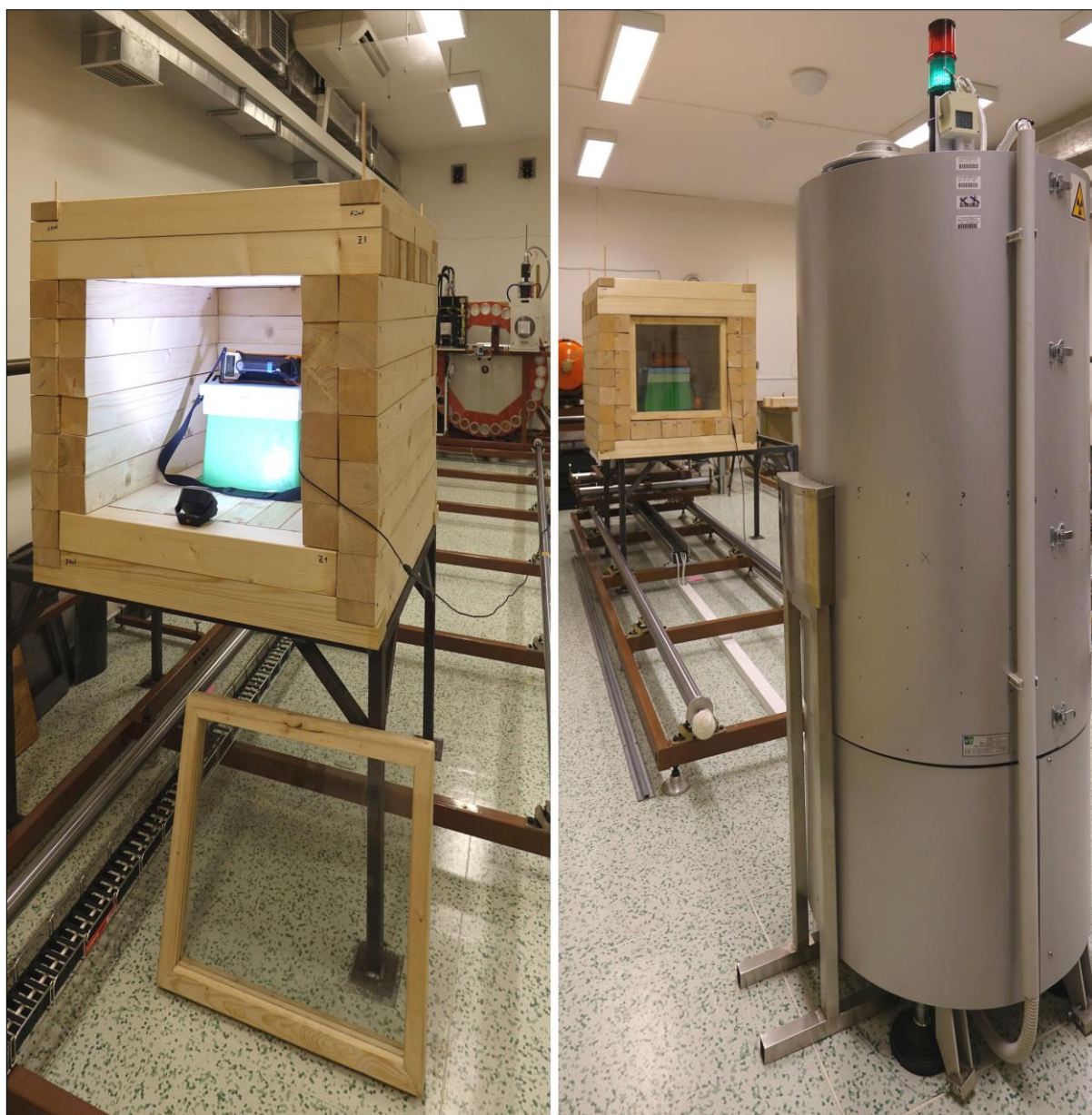
Obrázek 4: Kalibrační laboratoř SÚRO – měření zeslabení svazků záření stěnami dřevostavby
