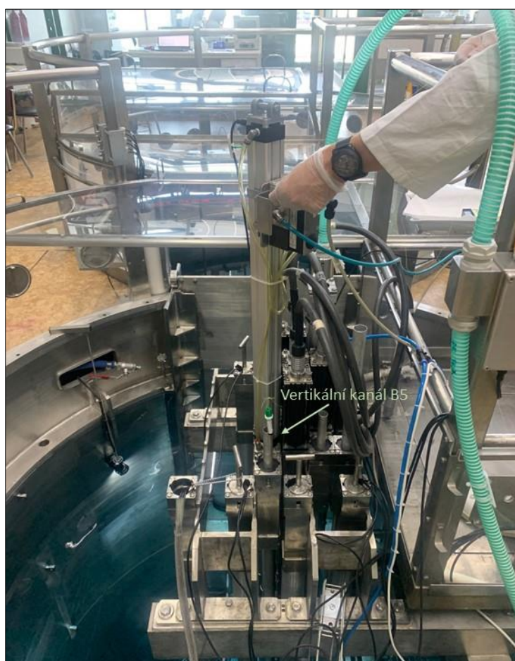
Obrázek 19: Ozařování vzorků krve v reaktoru VR-1
