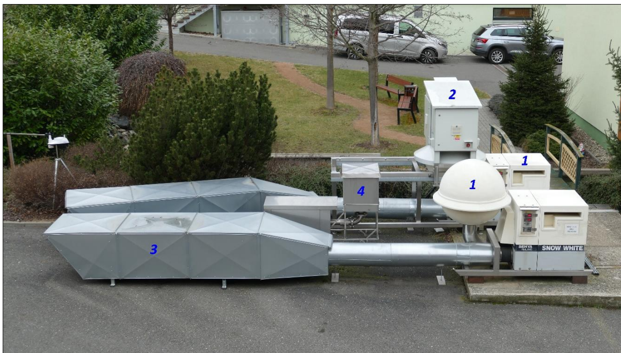
Obrázek 9: Velkoobjemová odběrová zařízení aerosolů a plyných forem jódu „Snow White“ v areálu SÚRO Praha
