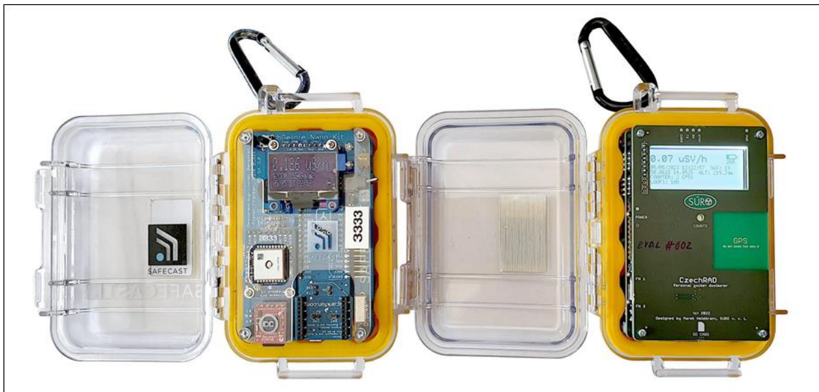
Obrázek 20: Přístroj SAFECAST bGeigie Nano (vlevo) a nově vyvinutý CzechRad (vpravo)
