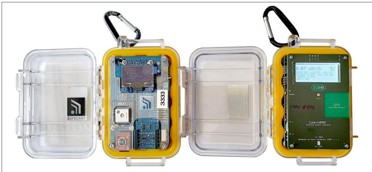
Obrázek 3: Měřicí přístroje Safecast bGeigie Nano (vlevo) a CzechRad (vpravo)
