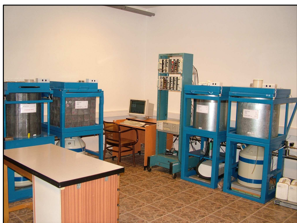
Obr.1.5. Kapalinové scintilační spektrometry pro stanovení tritia
