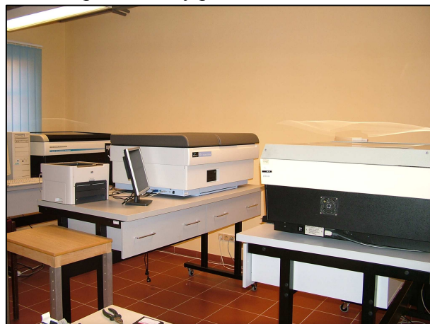
Obr.1.5. Kapalinové scintilační spektrometry pro stanovení tritia
