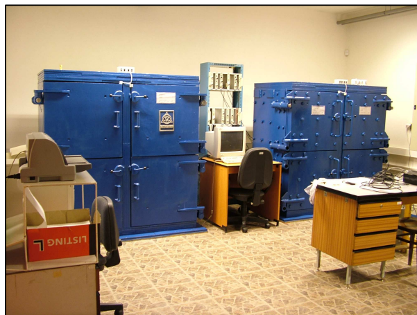
Obr.1.2. Ocelové stínící dvojkobky spektrometrie gama
