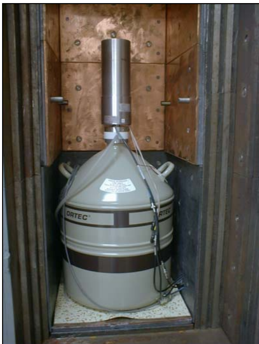
Obr.1: Polovodičový detektor o relativní účinnosti 150% pro detekci záření gama umístěný v ocelovém stínění.
