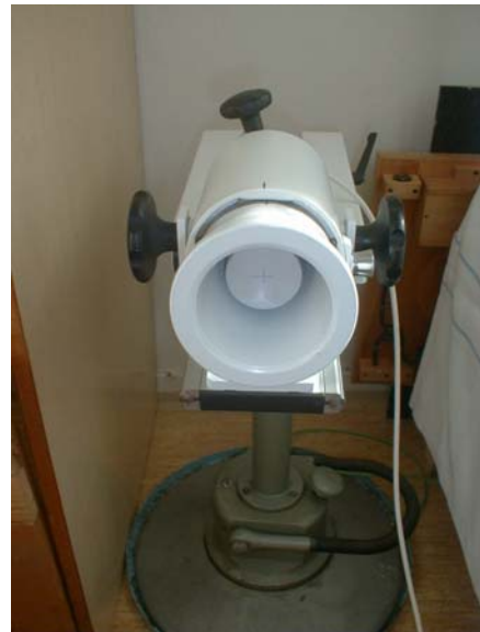
Obr. 2: Scintilační detektor s kolimátorem pro stanovení aktivity radioizotopů jodu ve štítné žláze
