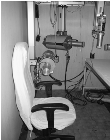
Obr. 1: CTP po rekonstrukci – uspořádání pro celotělové měření sedící osoby (po otočení křesla o 90°)
