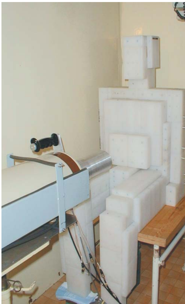
Obr. 4 - Kalibrační fantom IGOR v sedící poloze. Je měřen detektorem HPGe (117%).
