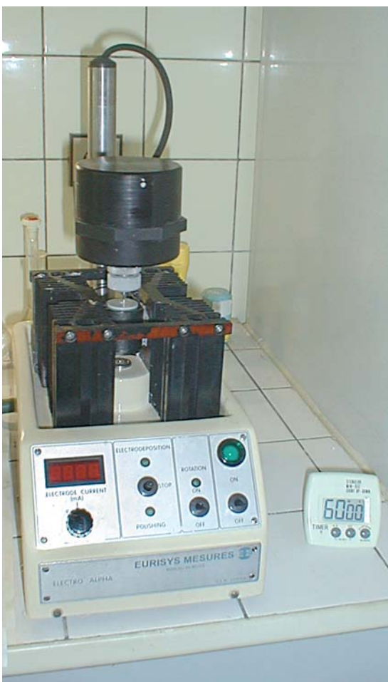
Obr. 3 - Zařízení pro elektrodepozici aktinidů na nerezové disky před jejich měřením pomocí spektrometrie alfa
