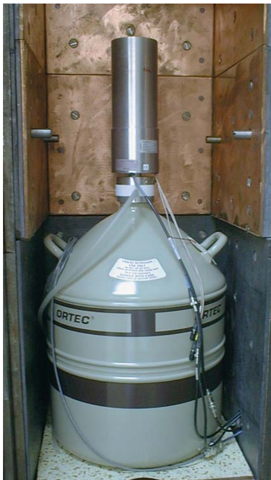
Obr. 1 - Polovodičový detektor o relativní účinnosti 150% pro měření záření gama, umístěný v ocelovém stínění
