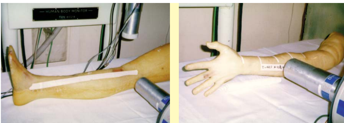
Obr. 5a, b - Kalibrace měřicího systému pro vyhodnocení ^{241}\text{Am} v kostře
