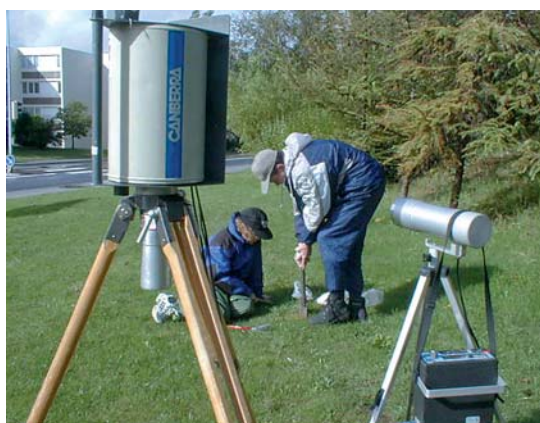
Obr. 3 - Mobilní skupina při monitorování pomocí in situ spektrometrie s HPGe detektorem (vlevo), měření příkonu dávkového ekvivalentu scintilační sondou NB 3201 (vpravo) a odběru půdy.
