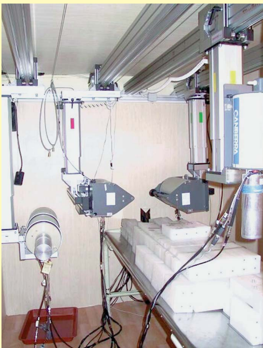
Obr. 3 - Vnitřní vestavba v komoře. Kalibrační fantom IGOR je měřen polovodičovým detektorem HPGe, posouváním do různých poloh nad ležící postavou. Vlevo je velký HPGe detektor pro měření sedící osoby. Dva LEGe detektory jsou obráceny ke stěně (mimo pracovní polohu).
