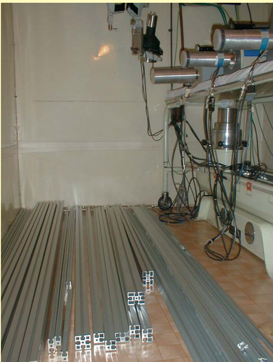
Obr. 2 - Měření duralových tyčí pro nový posuv detektorů. K měření použito 2 LEGe detektorů a 1 HPGe detektoru. Na obrázku vpravo je vidět starý stojan s jednou scintilační sondou.
