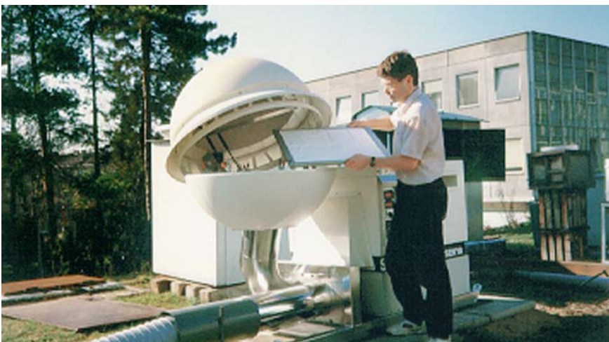
Obr. 2 - Výměna aerosolového filtru v odběrovém zařízení Snow White pro odběr aerosolů a plyných forem jodu s průtokem 900 m 3 /h. Zařízení je součástí sítě MMKO.
