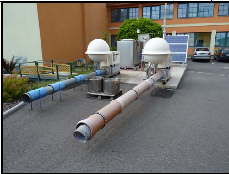
Odběrová zařízení aerosolů „Snow White“, každé s průtokem 900 m 3 /h
