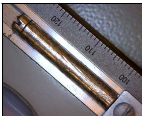
Obr. 7 Nalezený a vyčištěný záříč ^{226}\text{Ra} (A), autoradiograf (B)
