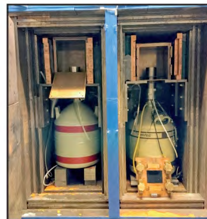
Dvojitá stínící kobka z 20 cm oceli s měděným dostiňením vybavená HPGe detektory
