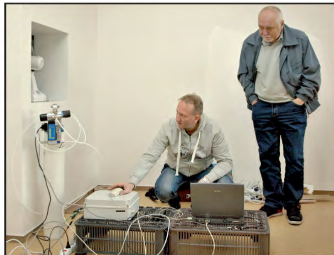
Pracovníci odboru Ladislav Moučka a Karel Jílek kontinuálně měří ventilační koeficient metodou stopovacích plynů
