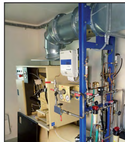
Zařízení na odradonování vzduchu (vzduchu s minimální objemovou aktivitou radonu) pro potřeby nízkoaktivních laboratoří v SÚRO Praha
