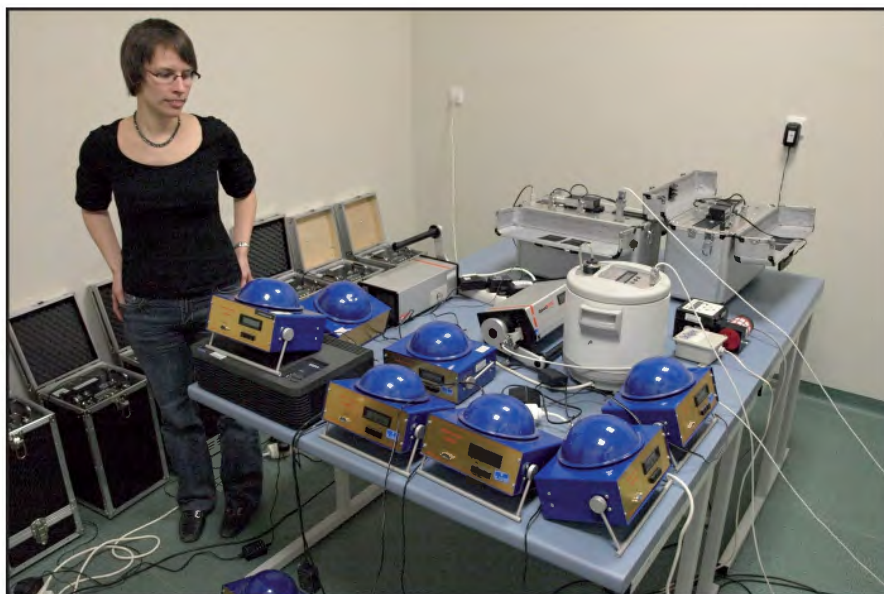
Srovnávací měření kontinuálních monitorů ve velké radonové komoře
