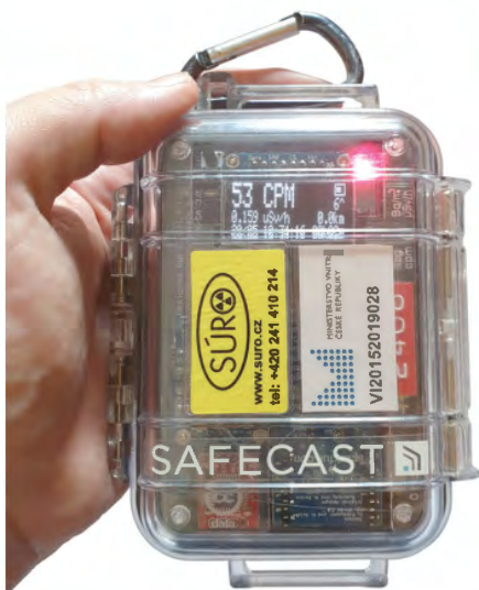
RAMESIS – mobilní detektor SAFECAST bGeigie Nano (vlevo) a ukázka naměřených dat v programu QGIS (vpravo)
