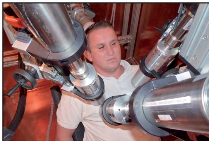
Unikátní sestava 4 HPGe detektorů speciálně určené pro stanovení radionuklidů s nízkými energiemi záření gama a X (obvykle v lebce) nebo pomocí 3 detektorů v plicích
