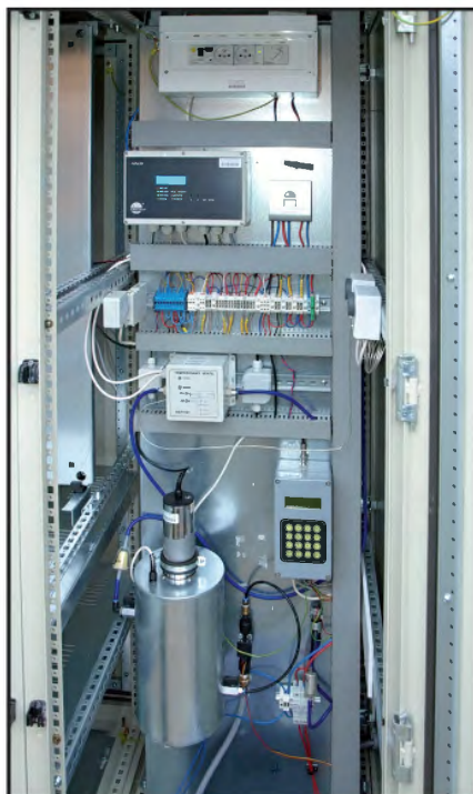
Venkovní měřicí stanice RAMONIS je vybavena monitory objemové aktivity radonu, thoronu a jejich produktů přeměny
