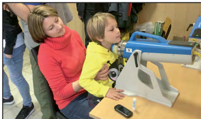
Systém sond pro měření velkého počtu osob na obsah radiojodu
