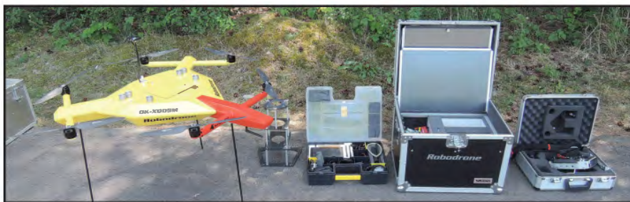
Vybavení mobilní skupiny – dron s detektorem dávkových příkonů
