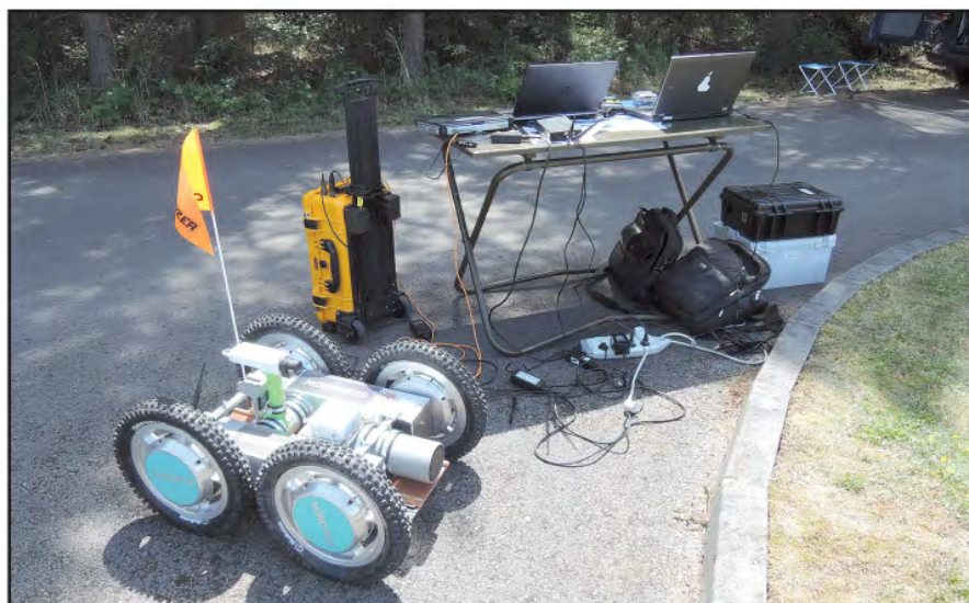
Vybavení mobilní skupiny – robot s detektorem dávkových příkonů
