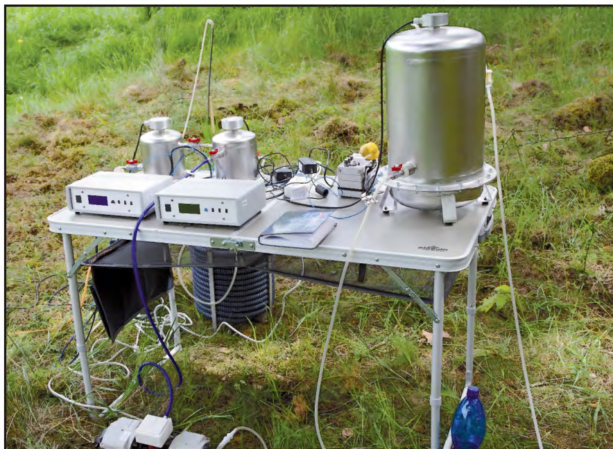
Aparatura umožňující kontinuální měření objemové aktivity radonu v půdním vzduchu a v atmosféře
