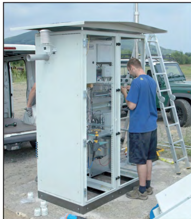
Zařízení na odradonování vzduchu (vzduchu s minimální objemovou aktivitou radonu) pro potřeby nízkoaktivních laboratoří v SÚRO Praha
