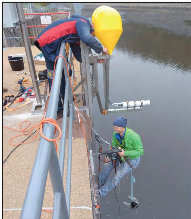
Spouštění a kotvení jednoho ze zařízení systému pro spektrální on-line měření aktivity radionuklidů pomocí scintilačního detektoru přímo v říční vodě
