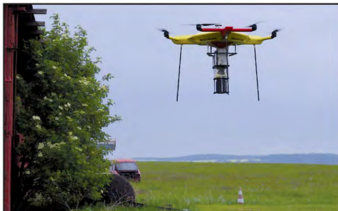
Monitorování pomocí detektoru umístěného na dronu
