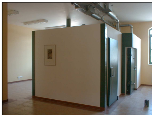
Obr 1.1: Ocelové stínící kobky celotělového počítače pro stanovení vnitřní kontaminace měřením osob in vivo
