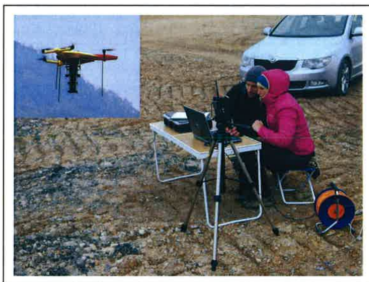
Obr. 2 Využití bezpilotního letadla při terénní letecké gamaspektrometrii
