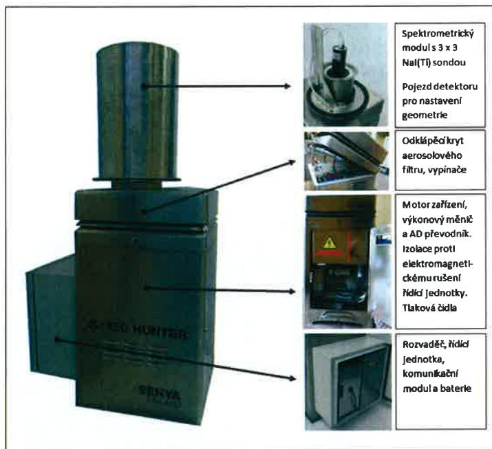
Obr. 5 Modernizované odběrové zařízení Hunter s dálkově ovladatelným průtokem a s online měřením pomocí spektrometrie gama nad filtrem
