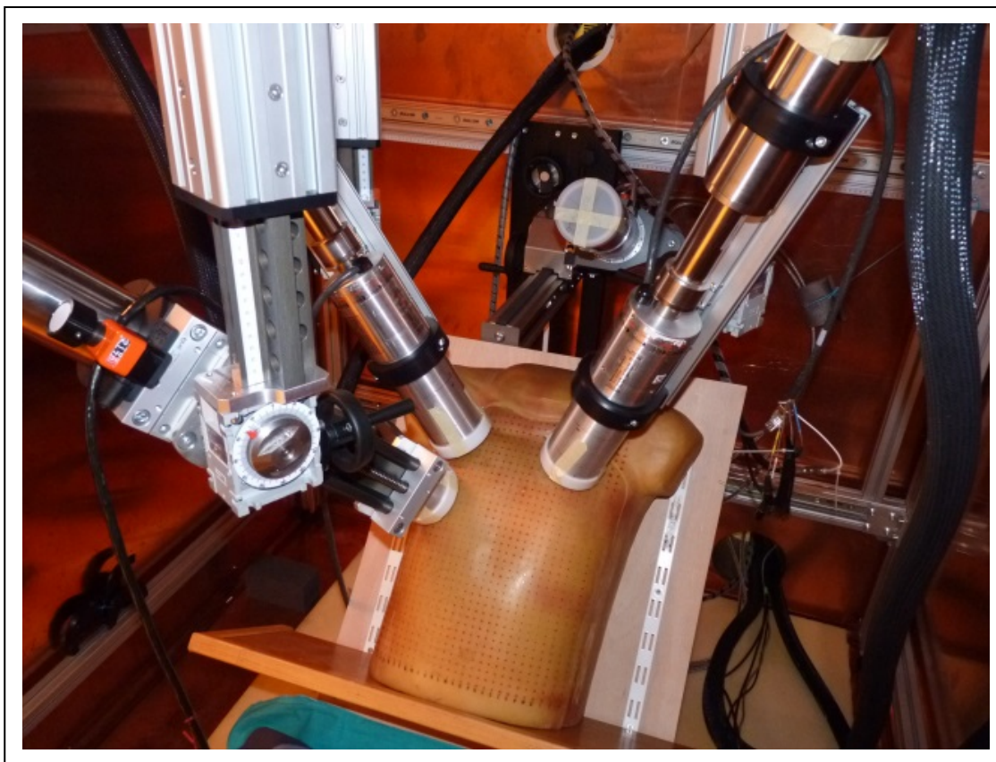
Obrázek 5 Hardware systém pro kalibraci sestavy tří detektorů pro měření aktivity transuranů v plicích pomocí fantomu
