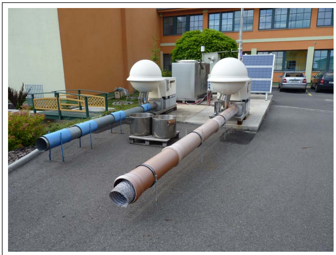
Obrázek 2 Zařízení na kontinuální odběr aerosolů s průtokem 150 \text{ m}^3/\text{h} z ovzduší v areálu SÚRO
