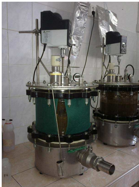
Obrázek 8: Experimentální fermentor pro testy zpracování radioaktivní biomasy v bioplynové stanici
