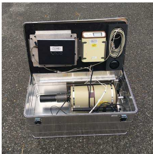
Obrázek 7: Unikátní letecký monitorovací spektrometrický systém na bázi HPGe
