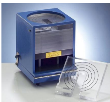
Obrázek 9: Fantom pro měření dávek pro rentgenové svazky nízkých energií
