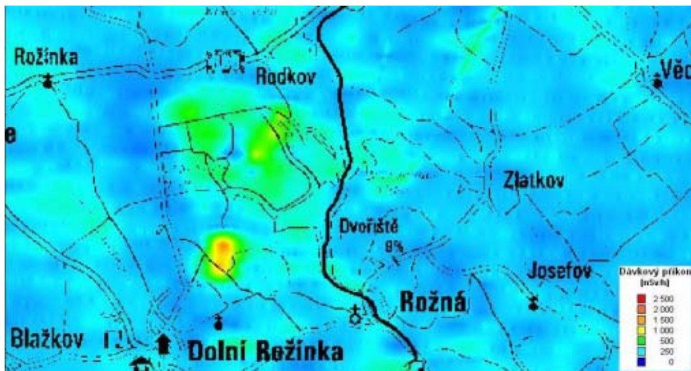
Obrázek 6 Rozložení příkonu efektivního dávkového ekvivalentu gama záření, přepočteného na výšku 1m nad zemí (letecká skupina SÚRO ve spolupráci s Armádou ČR)
