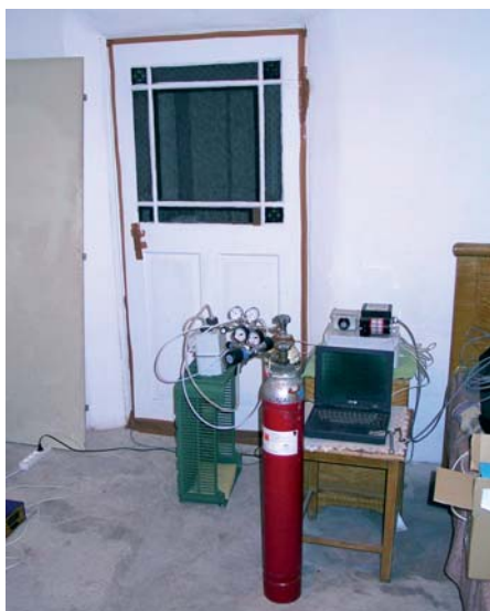
Měření násobnosti výměny vzduchu v budově.
