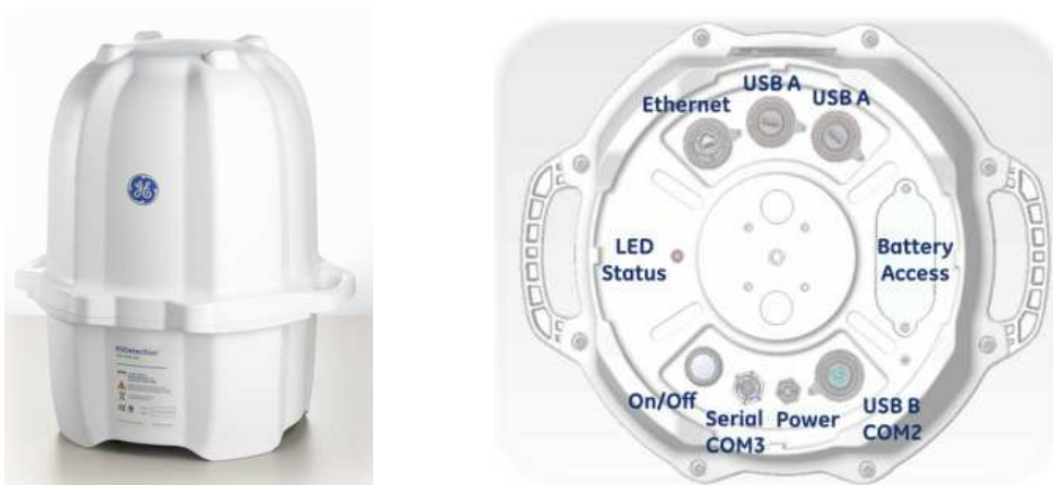
Obr. 17 Reuter-Stokes vč. horního krytu s konektory a spouštěcím tlačítkem
