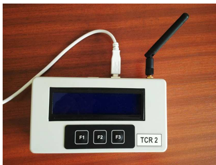
Obr. 19 Bezdrátový modul přenášející data ze sond do počítače
